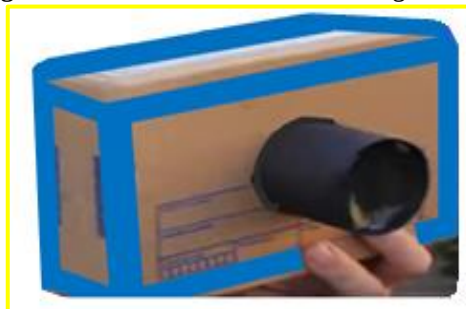
Figura 6 – Câmara escura com foco regulável
