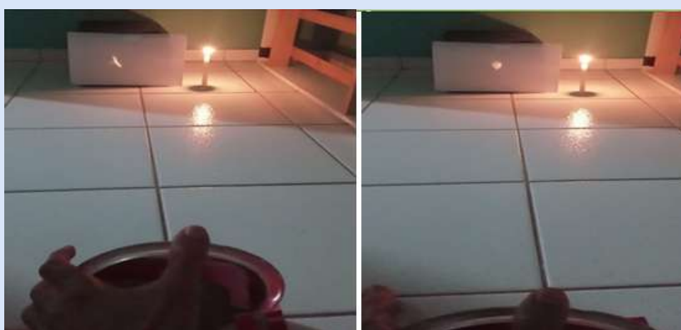
Figura 6.12: Imagem do experimento da distância focal de um espelho côncavo
