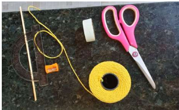
Figura 8.1: Materiais para construção do teodolito caseiro
