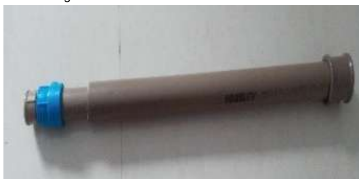
Figura 6.3: Luneta artesanal de cano PVC
