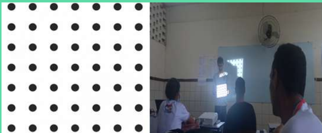
Figura 3.2: Reprodução do experimento da lei do quadrado da distância
