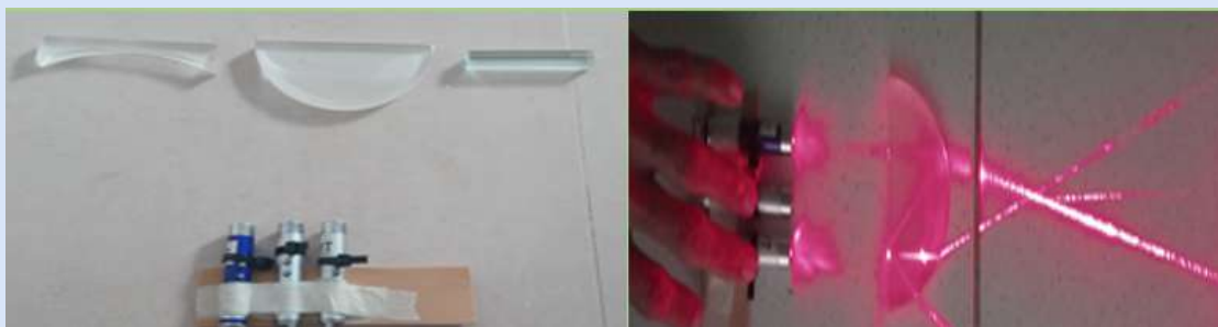
Figura 6.7: Representação da refração de lasers paralelos em lentes convergentes e divergentes
